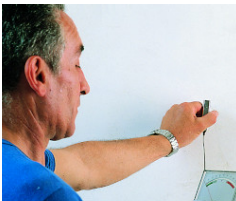
Vakolat nedvességtartalmának ellenőrzése
