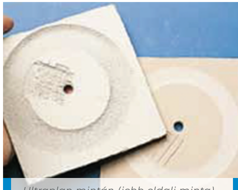
Ultraplan mintán (jobb oldali minta) és hagyományos aljzatkiegyenlítőn (baloldali minta végrehajtott Taber koptatási próba 200 fordulat után
