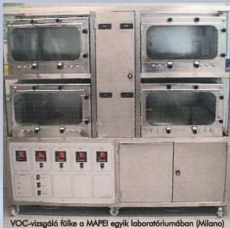
VOC-vizsgáló fűlke a MAPEI egyik laboratóriumában (Milano)
