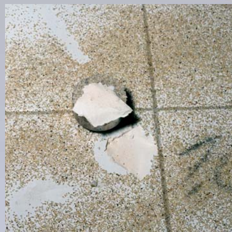
Tapadásvizsgálat MAPEPRIM SP -vel kezelt kerámia burkolaton.
